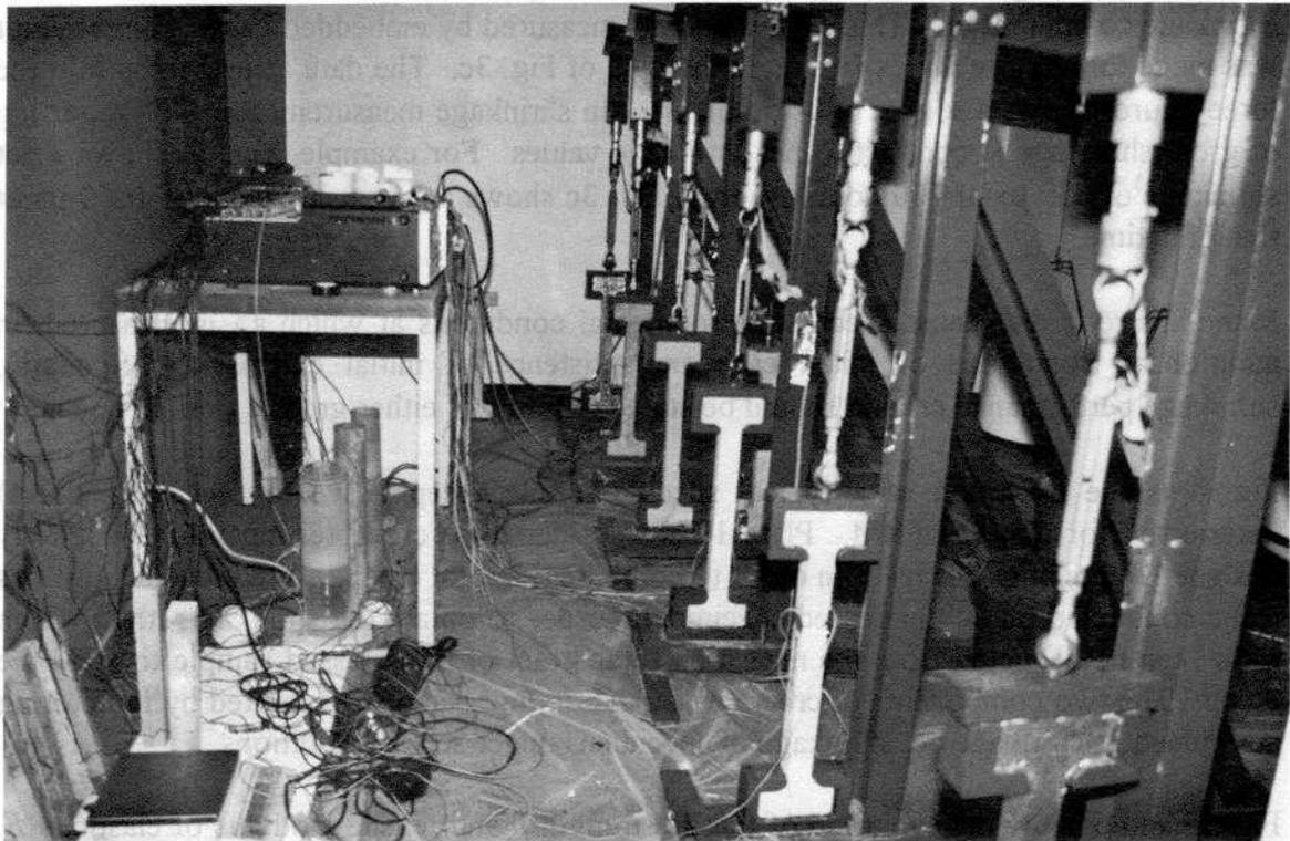
Plate 1. Tensile creep testing frames
