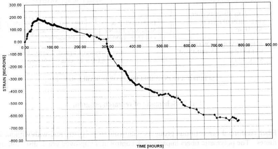
Fig. 3a.  $\epsilon_{sh}$  vs.  $t$  for material PMC (25\*25 mm)
