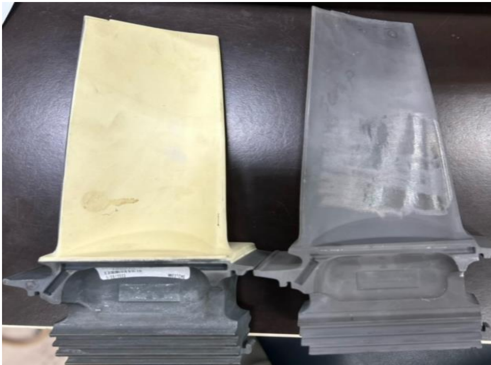
Fig. 29. Alloy 247LC base metal - Gas turbine blades.
