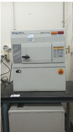
Figure 3.6: Rigaku® Mini Flex II XRD machine
