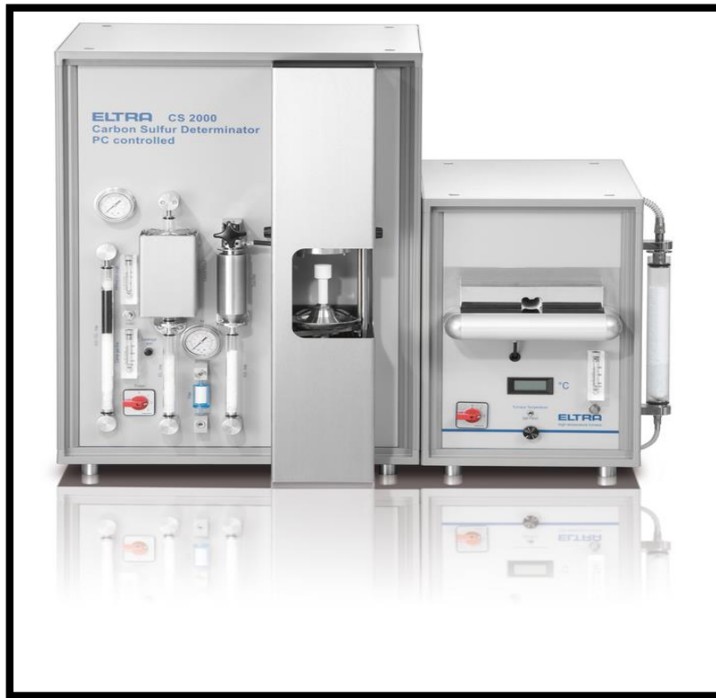
Figure9: Carbon Sulphur ELTRA CS 2000
